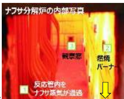
約在850°C時的輕油裂解爐的熱源將轉化為氫
